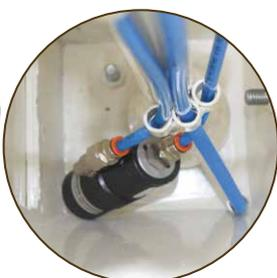
FINESTRA D'ISPEZIONE PER LO SCARICO DELLA POLVERE RIMANENTE E SISTEMA DI VIBRAZIONE
