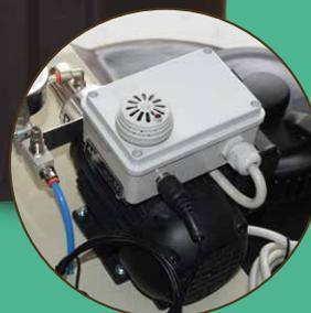
SISTEMA DI CONTROLLO DEL LIVELLO DEL LIQUIDO
