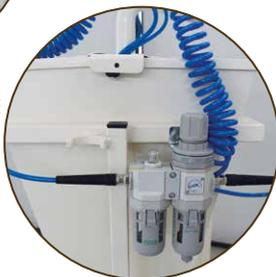
REGOLATORE D'ARIA PER IL SISTEMA DI VIBRAZIONE
