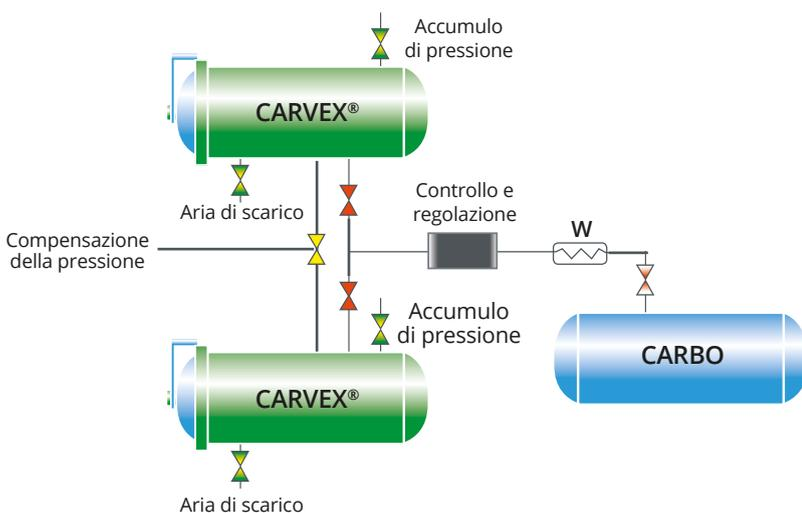
Per ovviare a questi limiti è stato progettato il Carvex®, una camera cilindrica "su misura" all'interno della quale vengono caricati i pallet o i big bag riempiti di derrate per venire sottoposti a disinfestazione con anidride carbonica in pressione.
